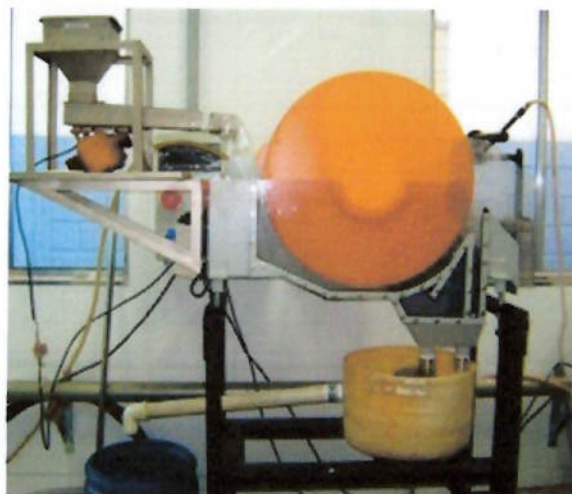
Figura 3. Fotografia do separador magnético de magneto permanente WDRE de 7 kG empregado nos testes.
